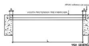
3 Det. de escoramento para vão de 6 a 10m
